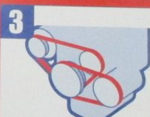
3 Vベルトの緩み・損傷
