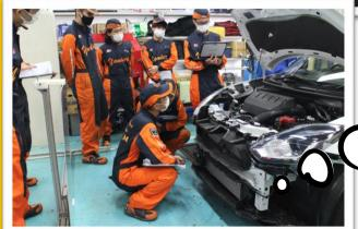
リフレクタプレート点検 ▶ ネジ調整中… <sub>-</sub> ◆
