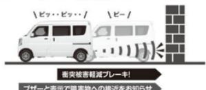
\*衝突被害軽減ブレーキ機能による車両停車後は、クランプ現象により後退しますので、必ずブレーキペダルを踏んでください。
