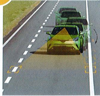
●車線逸脱警報:車載カメラにより道路上の車線を検知し、車線からはみ出しそうになった場合やはみ出した場合には、**運転者に対して警報**するもの
