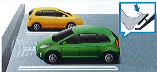
停止時や低速走行時に、車載レーダー等が前方や後方の障害物を検知している状態でアクセルを踏み込んだ場合には、**エンジン出力を抑える等**により、**急加速を防止**するもの
