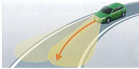
前方の先行車や対向車等を検知し、ハイビームとロービームを自動的に切り替える**自動切替型前照灯**、**自動防眩型前照灯**のほか、**配光可変型前照灯**があります
