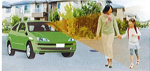
車載レーダー等により前方の車両や歩行者を検知し、衝突の可能性がある場合には、**運転者に対して警報**し、さらに衝突の可能性が高い場合には、**自動でブレーキが作動**するもの
