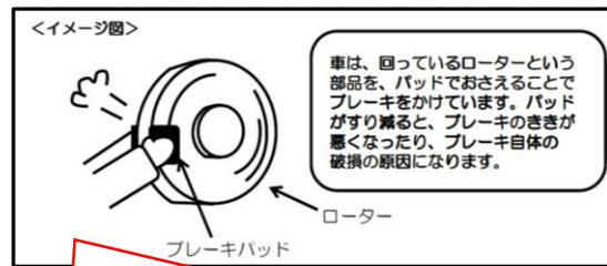
車は、回っているローターという部品を、パッドでおさえることでブレーキをかけています。パッドがすり減ると、ブレーキの利きが悪くなったり、ブレーキ自体の破壊の原因になります。
