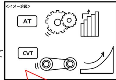
ATの変速は階段を上るようなもので、CVTの変速はスロープ式のエスカレーターだと思ってください！
