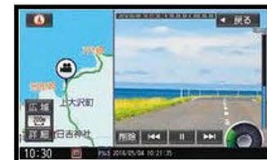
エンジンをかけている間前方の映像を常時録画し、衝撃を受けるとその前後の映像は自動的に保護されます。また、駐車中でも衝撃を検知すると自動で電源が入って録画してくれるため、当て逃げなどにも対応できます。
