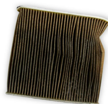
古い エアコン フィルター
