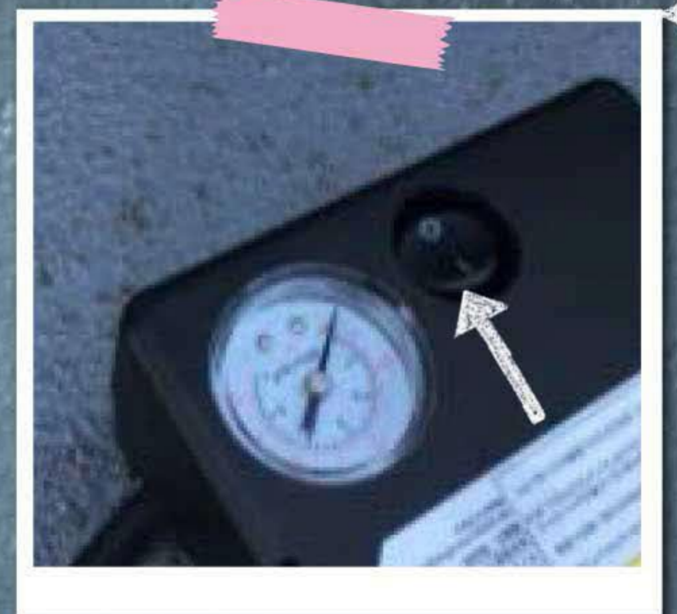
⑥ コンプレッサーのホース先端の金具をバルブに取付け、 電源プラグをアクセサリソケットへ差し込みスイッチオン！
