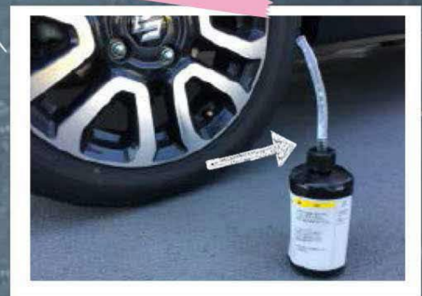
④ バルブコアを外したら、 修理剤の出番です。 チューブ付きキャップ 装着します。
